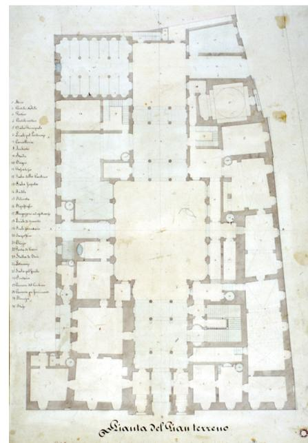
Fig. 14. Progetto dell'arch. Rodolfo Vantini per la pianta del piano terra di palazzo Thun (1833, Archivio Storico Comunale di Trento). Diversamente da quanto accadde per diversi punti ai piani superiori, i lavori ottocenteschi al piano terra furono fedelmente eseguiti come da progetto.
