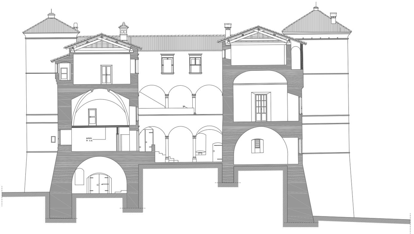
Fig. 10. Sezione trasversale in direzione nord-est/sud-ovest del castello, con vista verso l'ingresso alla corte.
